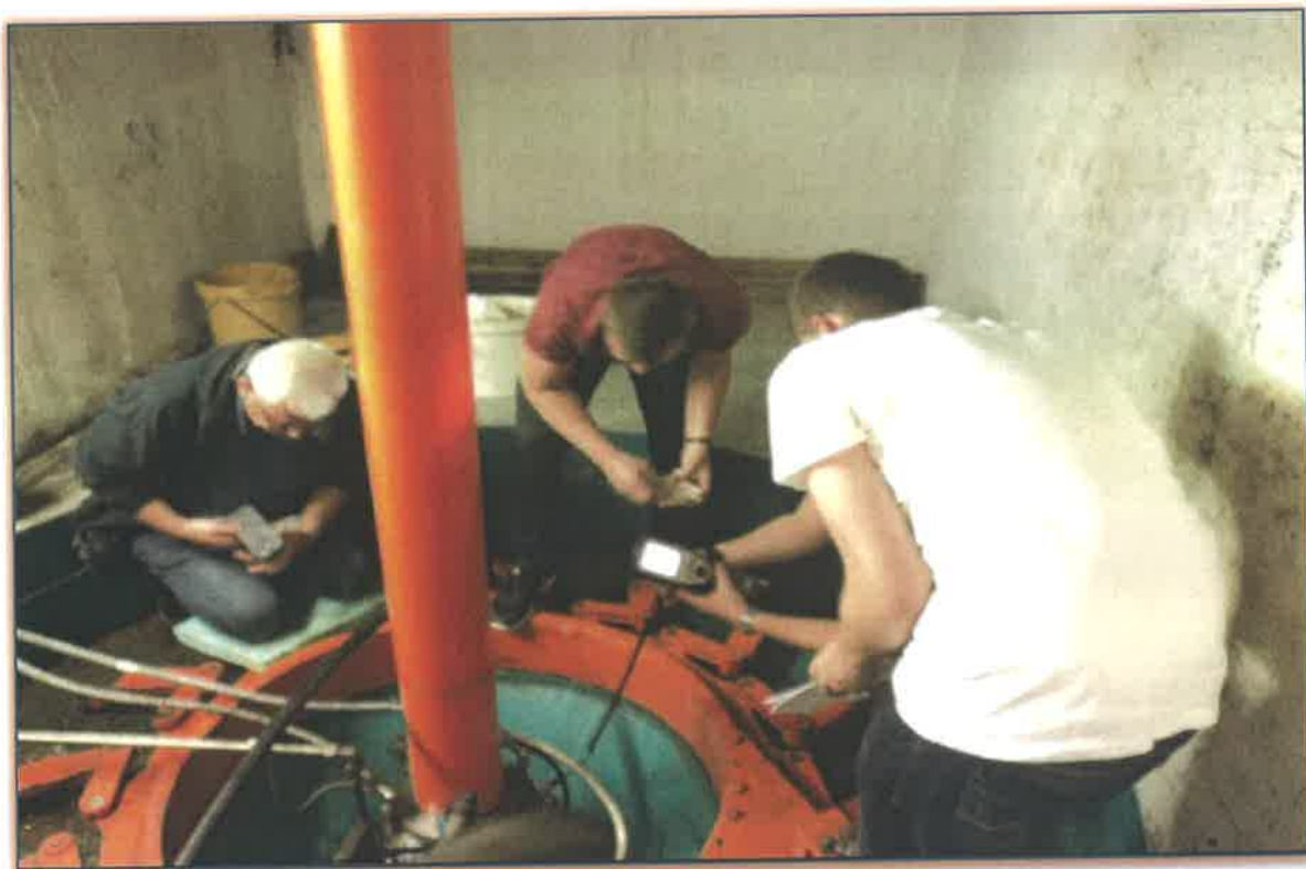
Slika - studenti vrše mjerenja vibracija na ležajima sistema turbina-generator
